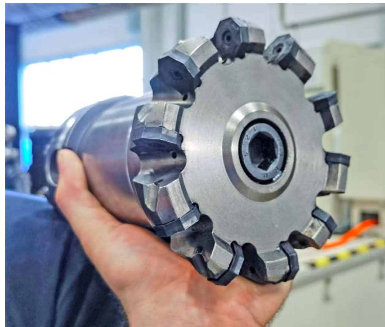
De NeoMill vlakfrees heeft een diameter van 125 mm en is uitgerust met tien indexeerbare wisselplaten.
