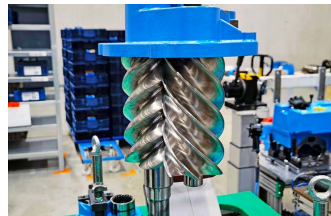
Een gedeeltelijk geassembleerde schroefcompressorassemblage, bestaande uit twee rotoren en de blauw gelakte lagerafdekking.
