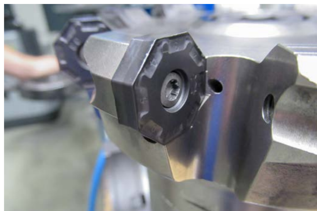
De ONKU indexeerbare wisselplaten hebben acht snijkanten aan elke kant. Zestien in totaal dus.
